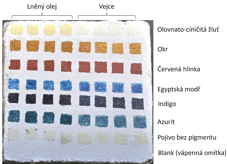
Obr. 6 Blok vápenné omítky se čtverečky (cca 1 cm 2 ) pojiv (lněný olej a vejce) se šesti různými pigmenty
