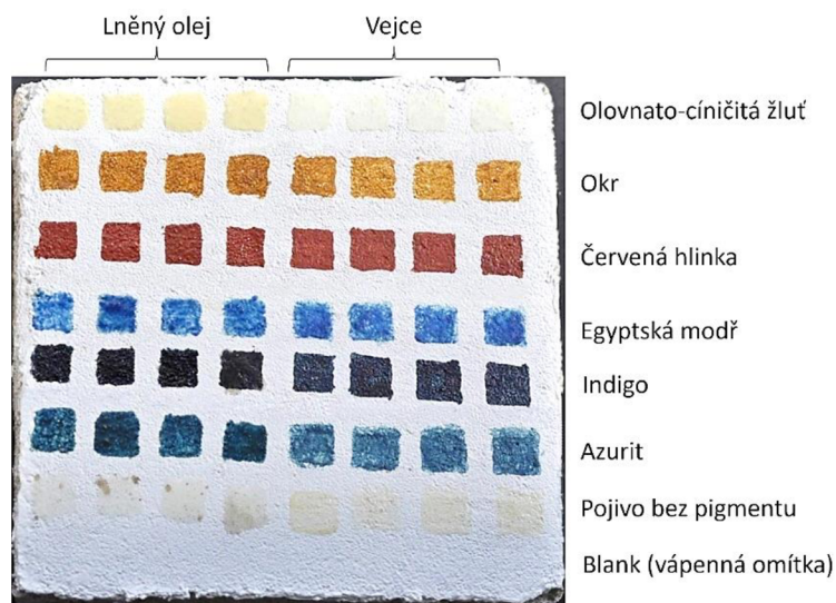
Obr. 1 Blok vápenné omítky se čtverečky (cca 1 cm 2 ) pojiv (lněný olej a vejce) se šesti různými pigmenty
