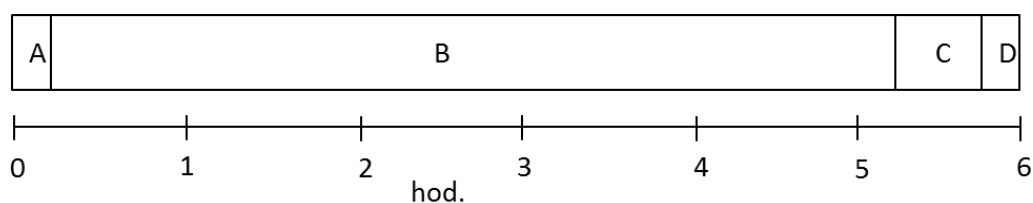
Obr. 5 – Průběh SBR cyklu: A) přítok, B) aerace, C) sedimentace, 4) odtok
