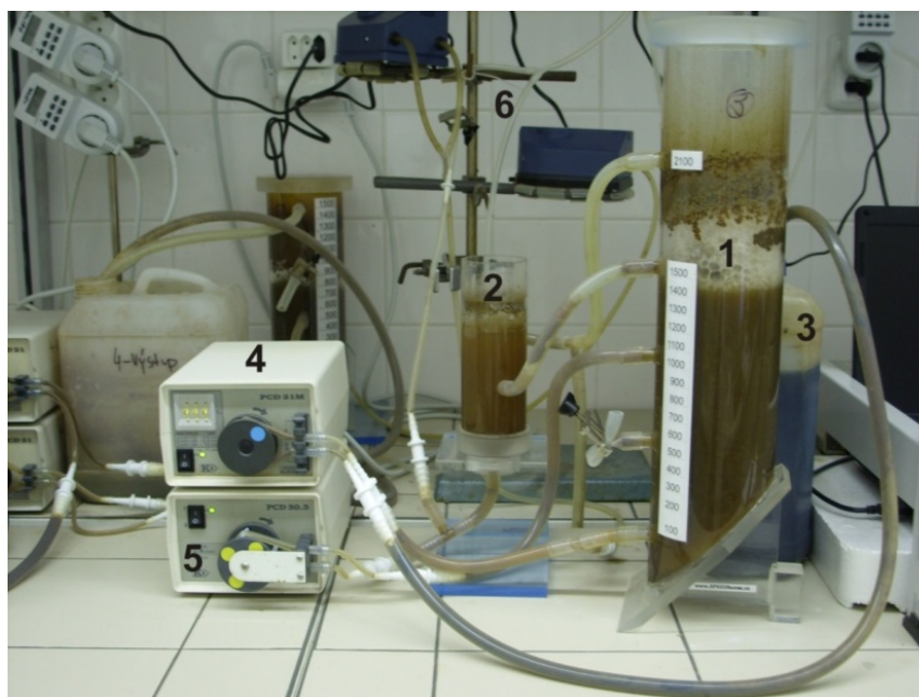
Obr. 2 – Modelový reaktor CSTR: 1) nitrifikační reaktor, 2) dosazovací nádrž, 3) vstup, 4) čerpadlo přivádějící kalovou vodu, 5) čerpadlo recirkulace aktivovaného kalu 6) aerace
