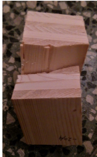
Obr. 54 Tlakový vzorek - porušení ve dřevě
