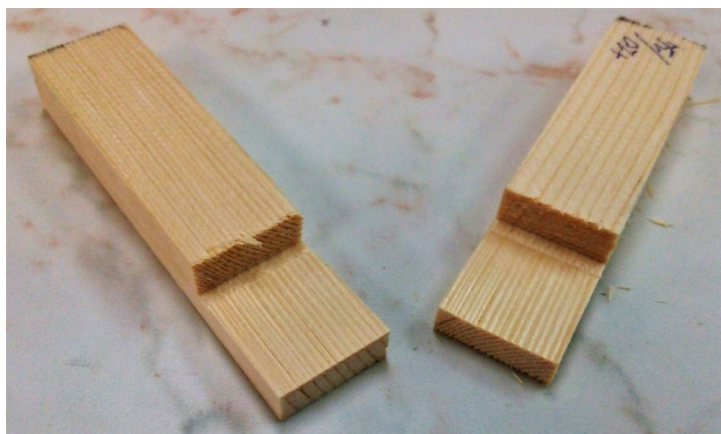
Obr. 52 Tlakový vzorek - hladké poškození
