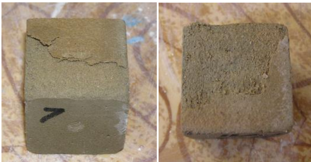
Obr. 47 Viditelné poškození povrchu opadem za zmrazovacích cyklů, na dvou vzorcích hmoty Weber.therm Technik - ostatní vzorky nebyly povrchově poškozeny [103]
