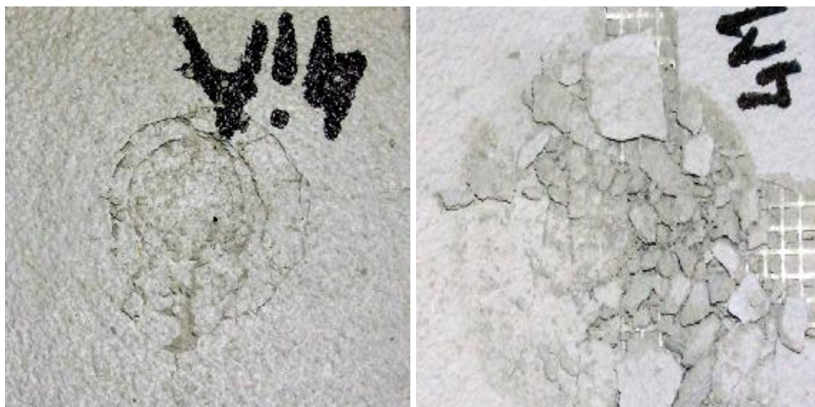
Obr. 52 Vzorky po provedení zkoušky odolnosti proti rázu - vlevo vzorek s poškozením „popraskáním“, vpravo vzorek s poškozením „destrukce, viditelná síť, opad“ [103]
