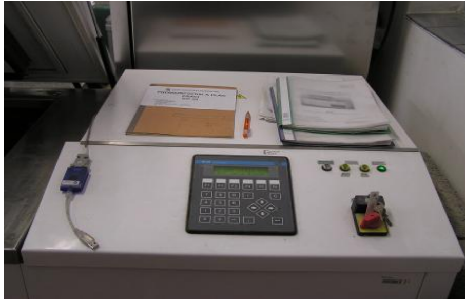
Obr. 36 Ovládací panel přístroje KD v laboratoři - slouží pro sledování průběhu a nastavení cyklů zmrazování - kabel umožňuje připojení PC pro záznam cyklů, v mém případě nebyl k dispozici [103]
