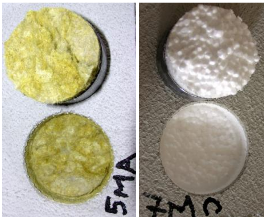
Obr. 51 Odrhové terče po provedení odtrhových zkoušek - vlevo vyhovující vzorek na minerální vatě, vpravo vyhovující vzorek na EPS - oba vzorky odtrženy ve vrstvě izolantu [103]
