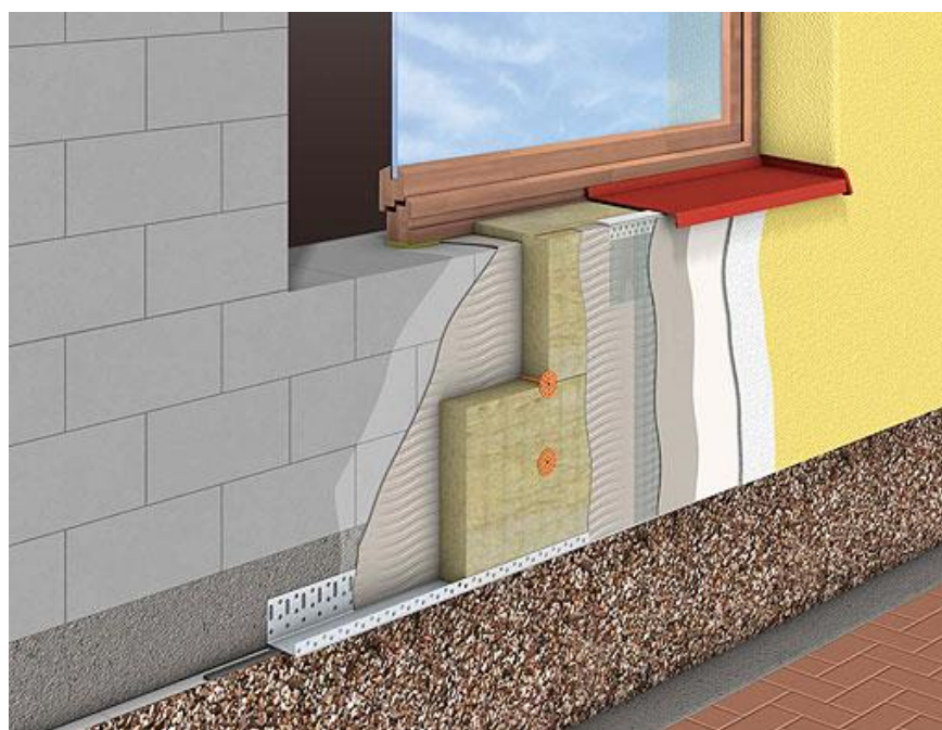
Obr. 9 Běžná skladba zateplovacího systému s izolantem z minerální vlny, popis totožný s obr. 5, obrázek ze stránek fy. Stomix [24]
