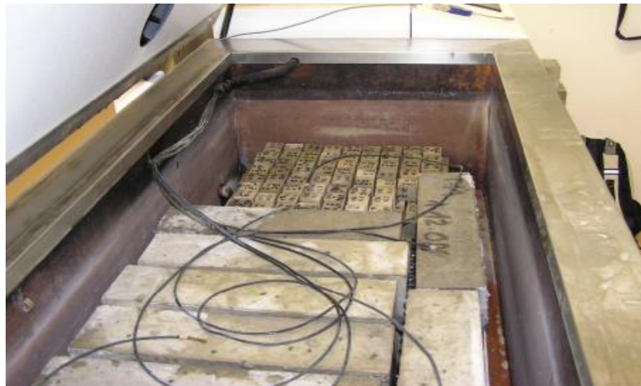
Obr. 37 Pohled na způsob plnění mrazícího zařízení - je vidět linii naplnění, kterou bylo nutné dodržet kvůli ohřívání ve vodním uložení [103]
