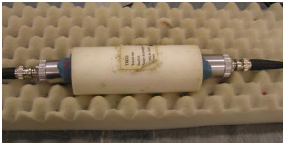
Obr. 31 Měření rychlosti a času průchodu impulsu etalonem - stav těsně po měření, v průběhu jsou sondy tlačeny k prvku rukama technika - principiálně stejně probíhá měření vzorků [103]
