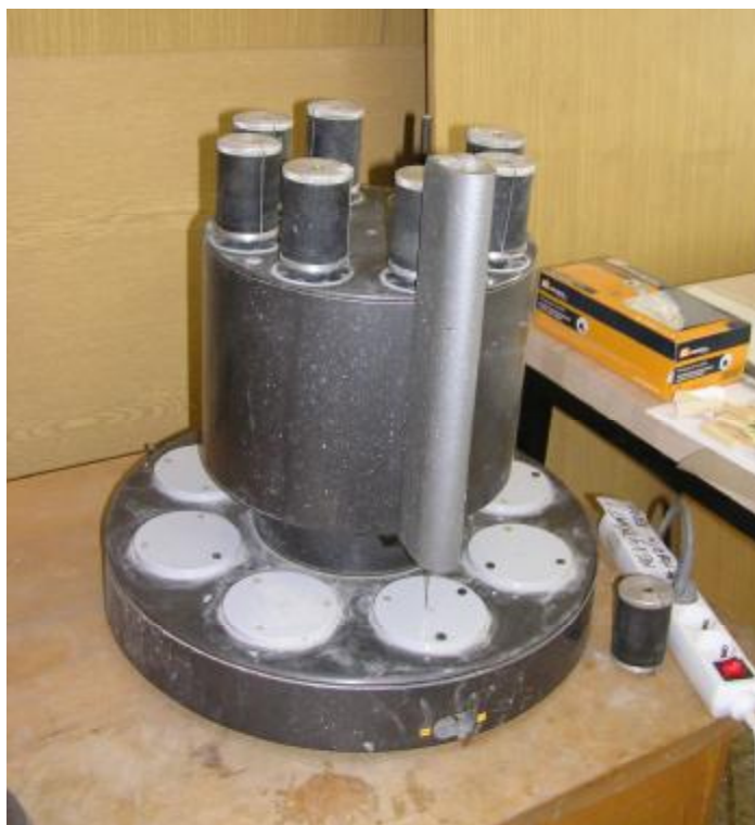
Obr. 23 Automatický Vicatův přístroj typu ARV-2 při přípravě na testování, (na záznamových válcích nahoře prozatím chybí milimetrový papír pro záznam hloubky vpichu jehly) [103]
