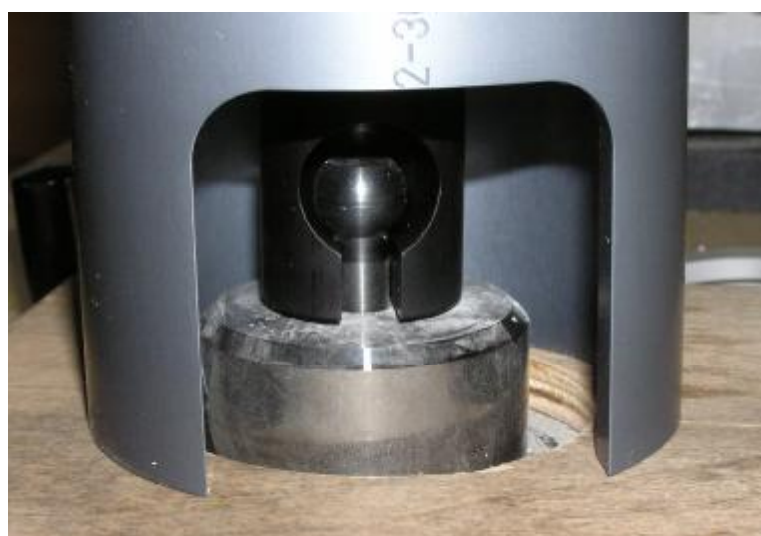
Obr. 39 Detail uchycení odtrhového terče v přístroji Dyna [103]
