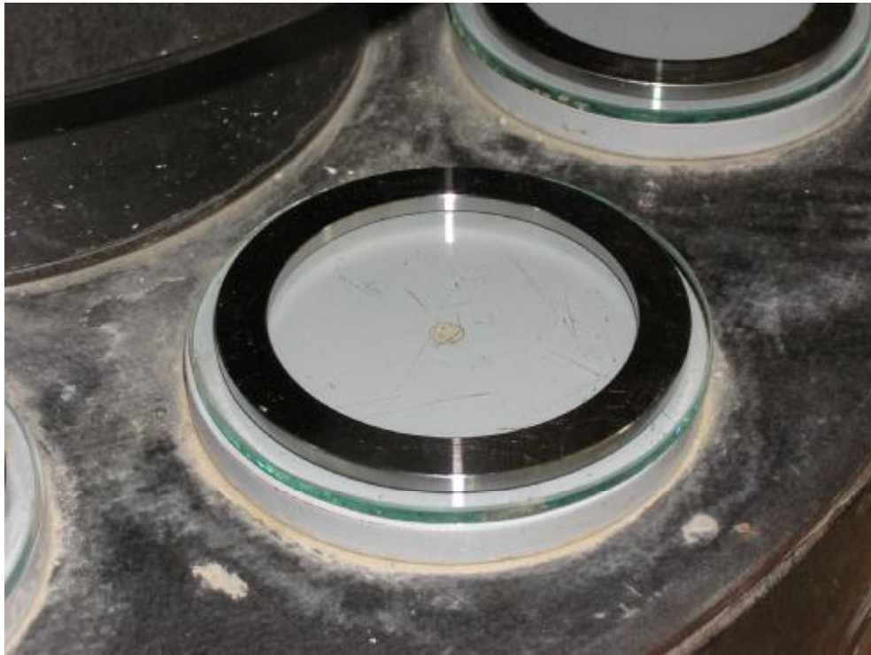
Obr. 25 Ocelové kroužky - prstence - které nahrazují standardní prsteneček pro zkoušky tuhnutí Vicatovým přístrojem [103]
