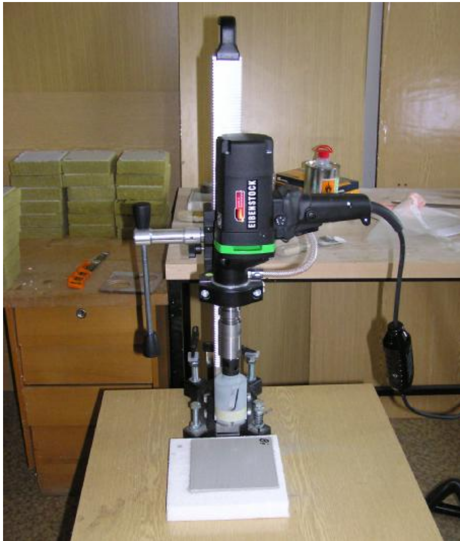
Obr. 38 Připravená sestava jádrové vrtačky s nasazenou korunkou pro jádrový vrt na vzorku pro odtrhovou zkoušku [103]
