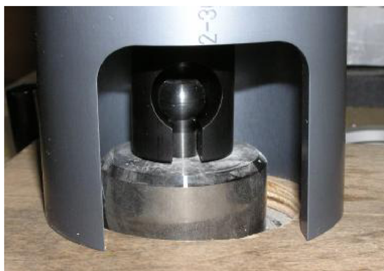
Obr. 39 Detail uchycení odtrhového terče v přístroji Dyna [103]
