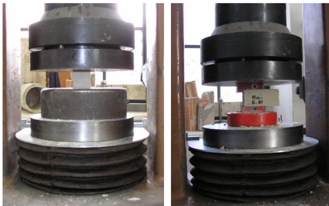
Obr. 35 Zkouška v tlaku - vlevo na krychli o hraně 40mm, vpravo na zlomku trámce v přípravku - viditelné poškození vzorku po dokončení zkoušky [103]
