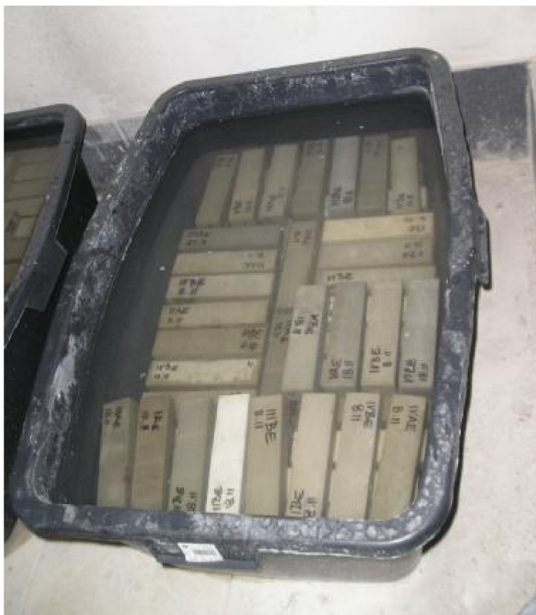
Obr. 27 Vzorky uložené ve vodní lázni pro dosažení plného nasycení - plně ponořené pod vodní hladinou [103]
