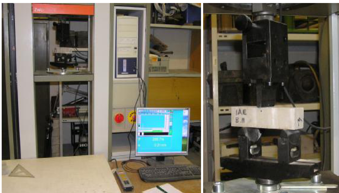
Obr. 33 Zkušební lis Zwick 1445 určený přímo pro zkoušky cementových a maltových hmot s přímým působením tlakové síly na běžný přípravek pro tah za ohybu, včetně PC pro záznam dat [103]
