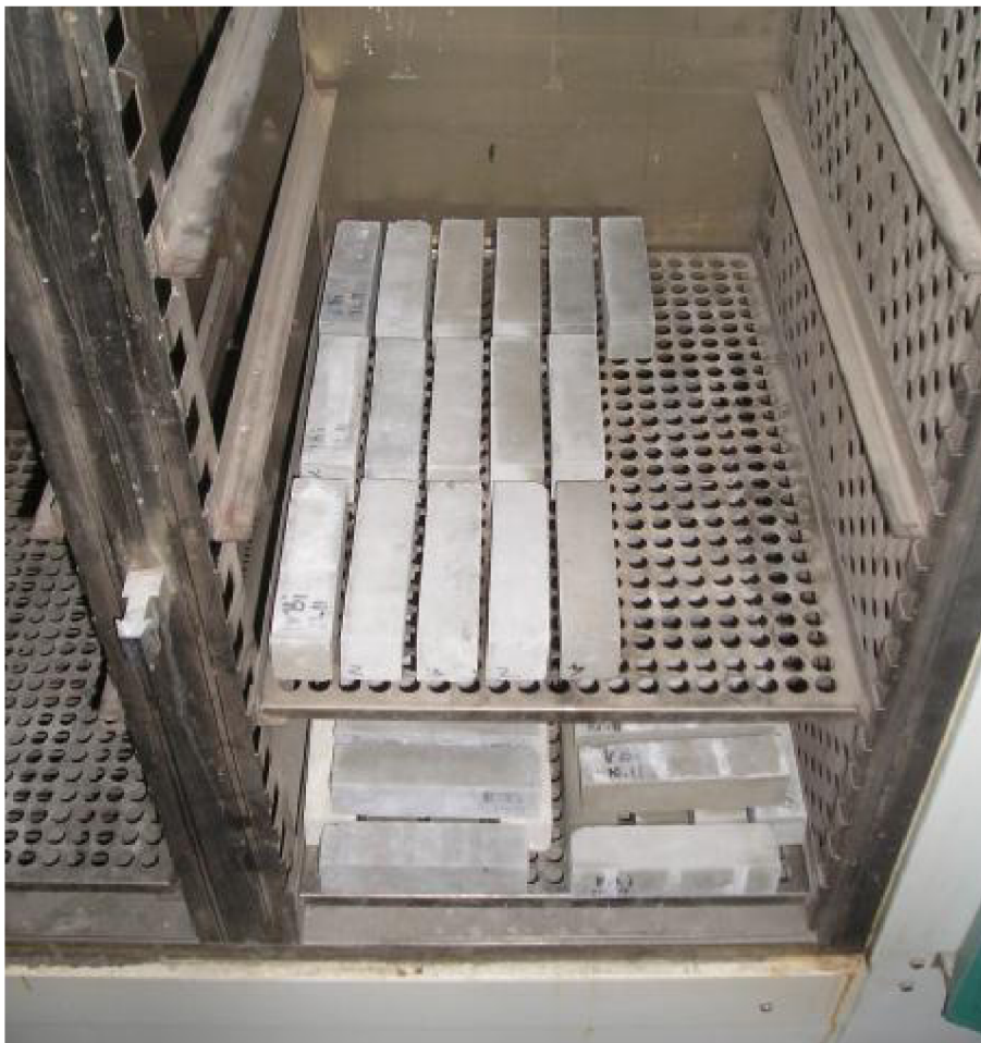
Obr. 29 Umístění vzorků v útrokách zařízení HS 400A [103]
