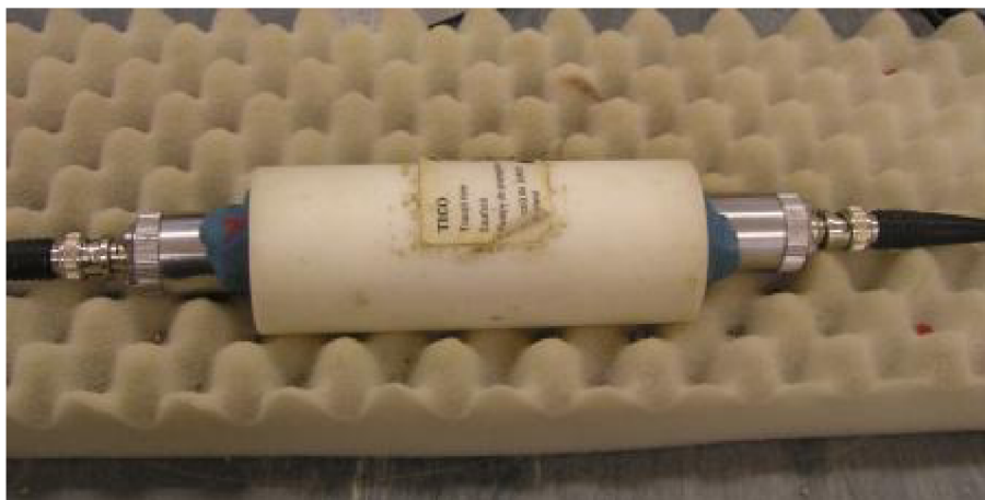
Obr. 31 Měření rychlosti a času průchodu impulzu etalonem - stav těsně po měření, v průběhu jsou sondy tlačeny k prvku rukama technika - principiálně stejně probíhá měření vzorků [103]
