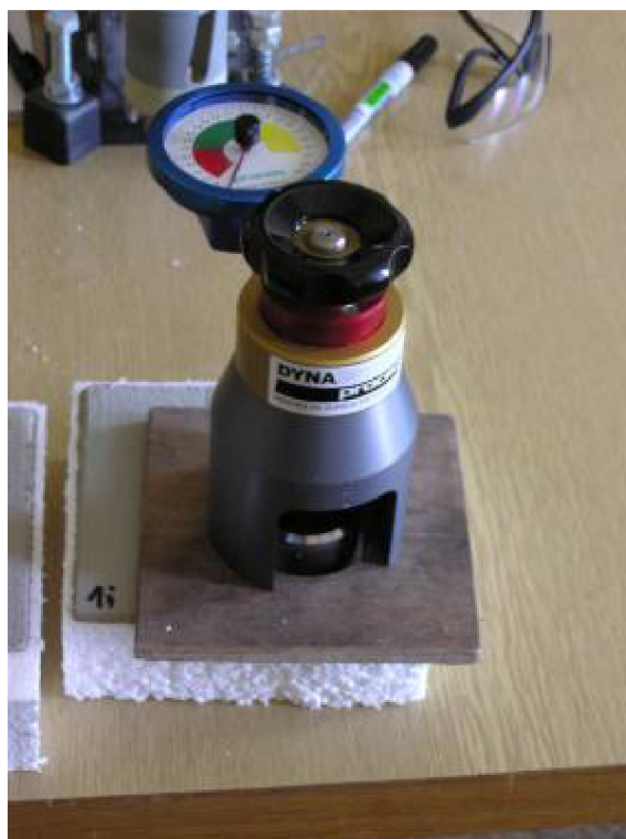
Obr. 40 Odtrhový přístroj fy. Proceq Dyna Estrich, připravený ke zkoušce [103]
