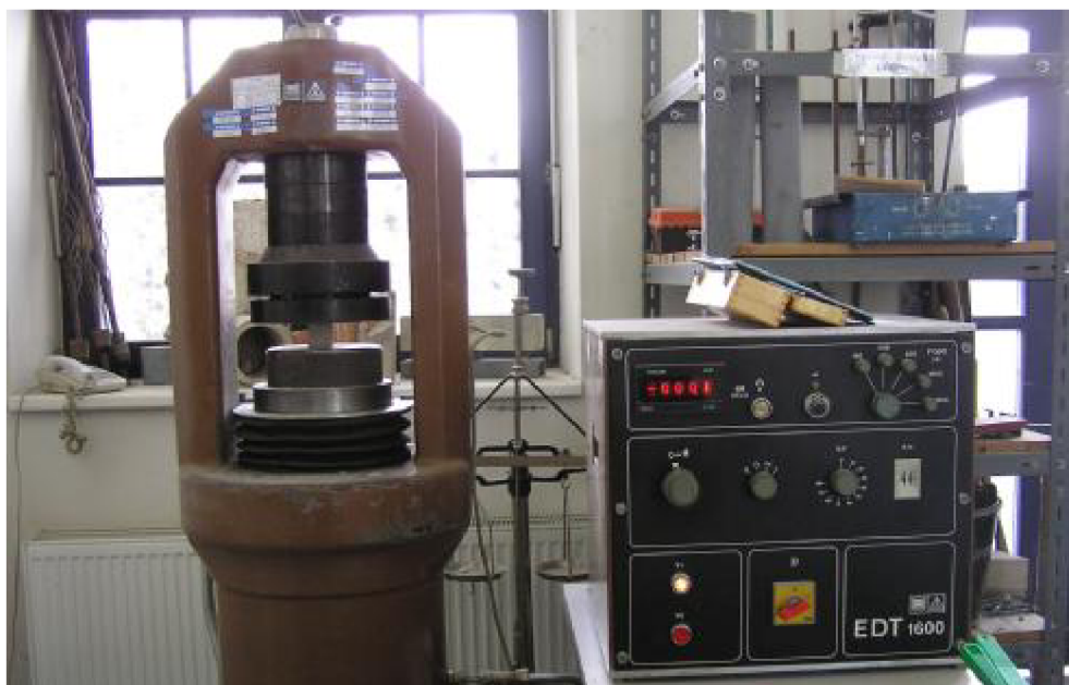
Obr. 34 Zkouška tlakem - lis EDT 1600 s odečtem na číselníku, s vloženým vzorkem, který byl upraven na tvar kostky o hraně 40mm [103]
