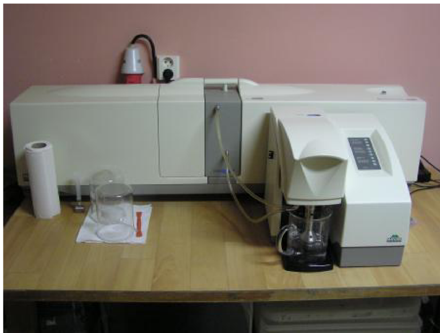
Obr. 21 Sestava přístroje Malvern Masterseizer 2000 včetně pomůcek pro měření velikosti částic laserovou difrakcí - laboratoře Ústavu technologie stavebních hmot a dílců [104]
