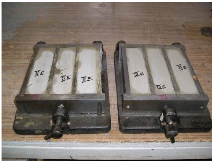
Obr. 26 Fotografie vzorků ve formách přinesených z exteriéru k odformování, viditelné označení hmoty vzorku II a E jako exteriér, viditelné částečné zavlhnutí vzorků na okrajích [103]
