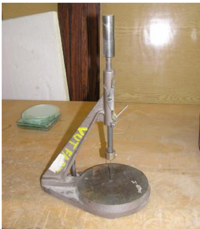
Obr. 24 Fotografie ručního Vicatova přístroje s osazenou jehlou pro zkoušení a hledání počátku a konce tuhnutí [103]
