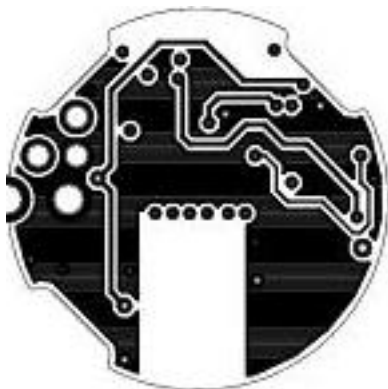
Obr. 47: Strana spojů SugarCube - vrstva LAYER2, měřítko 4:1
