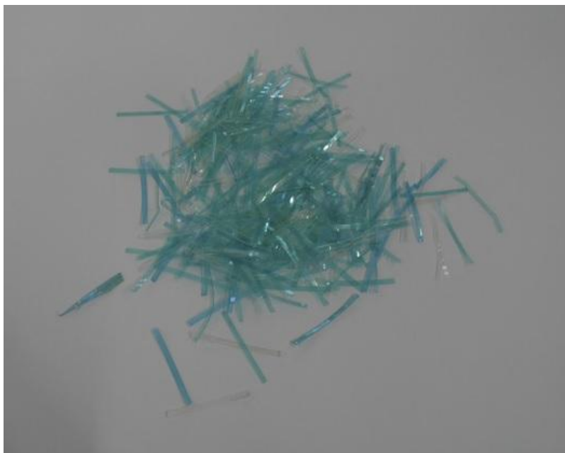
Obr. 16 : Vzorek krátkých PET proužků [28]
