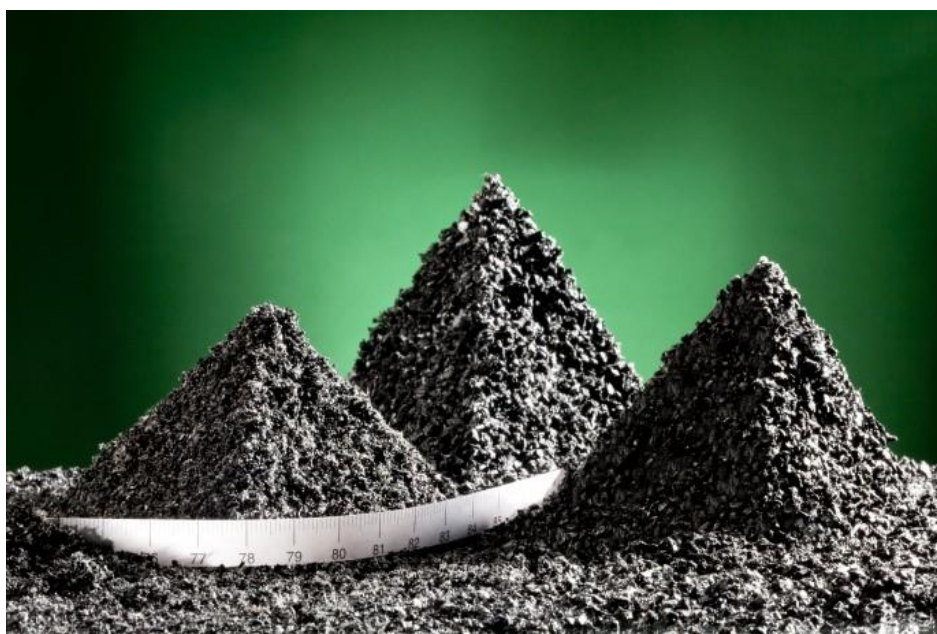
Obr. 11: Pryžový granulát z recyklovaných pneumatik [25]
