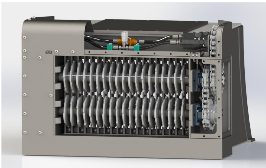
Obr. 17 Třídící lopata s částečně odkrytým pohonem, řetězovým převodem a hydraulickým okruhem
