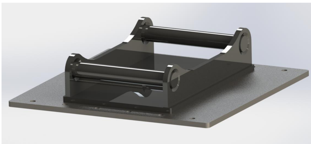
Obr. 18 Mezikus tvořený adaptérem pro upínač S45 přivařeným na základnu
