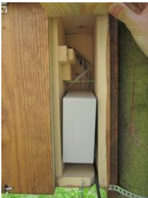
Příloha 2. Umístění řídicí jednotky v plastovém boxu v zadní části chytré budky (Zárybnická, vlastní fotoarchív).
