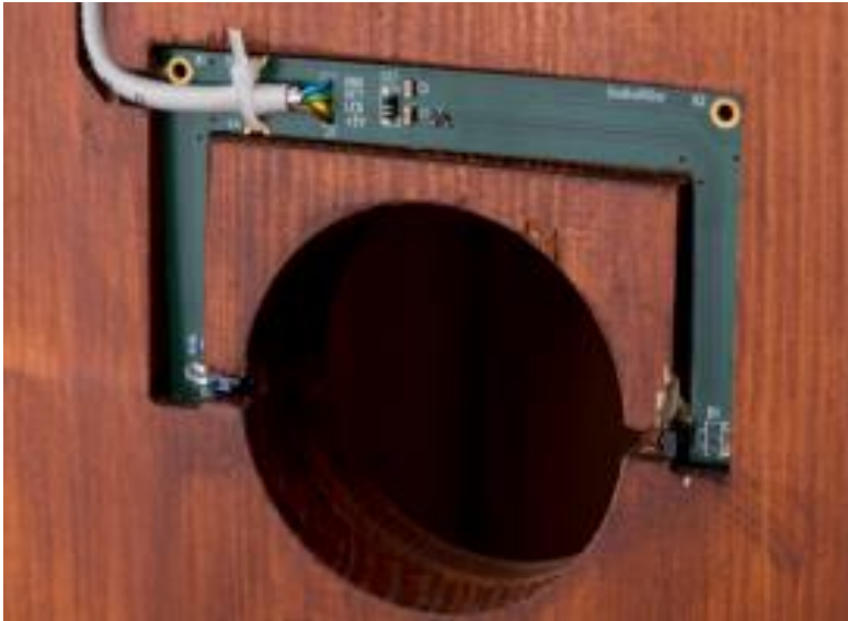
Příloha 3. Optický senzor snímající odlety a přiletý jedinců do budky, usazený v jejím otvoru (Zárybnická et al. 2016).
