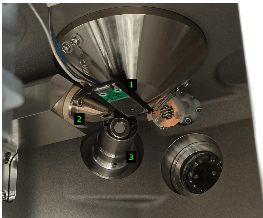
Obrázek 7 – fotografie zakončení elektronoptické soustavy v prostoru vzorkové komory SEM.
