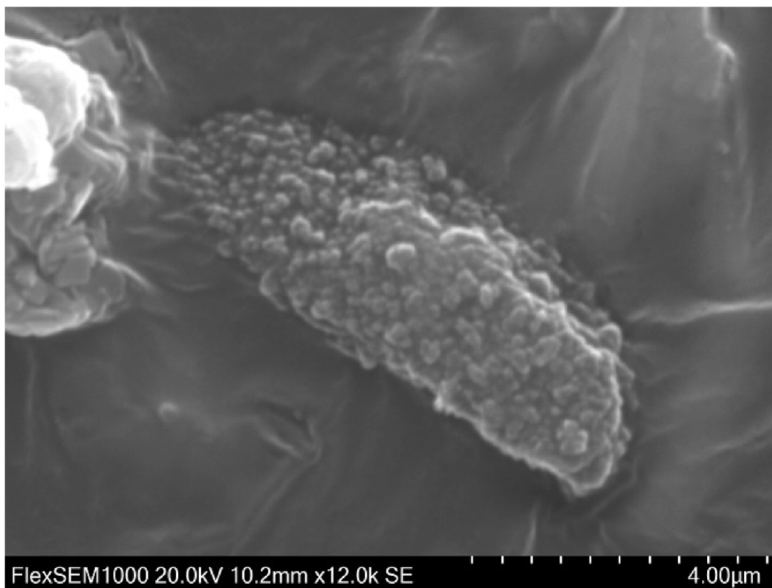
Obrázek 17 – organická částice podlouhlého tvaru s výrazně členitým povrchem
