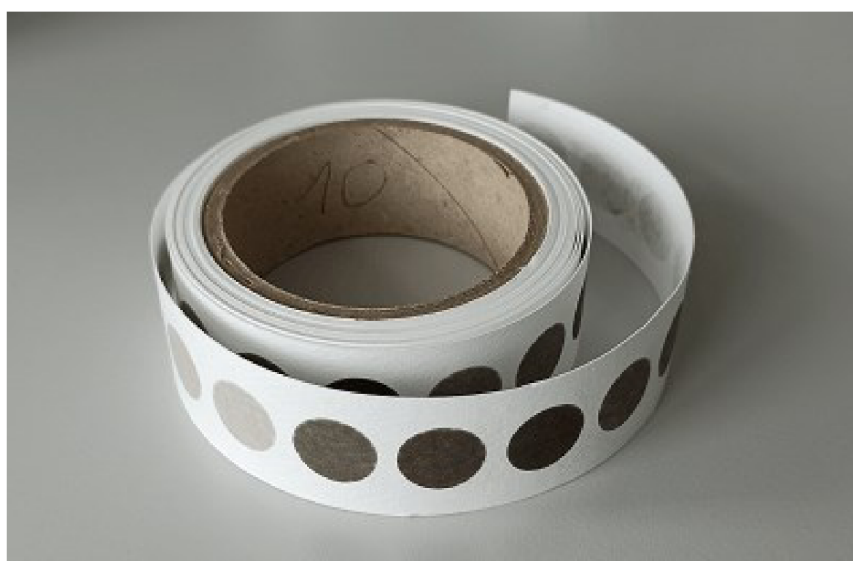
Obrázek 4 – filtrační páska s použitými filtry
