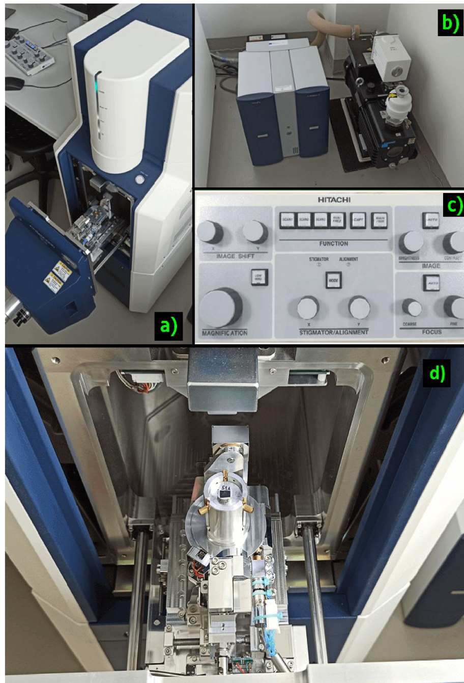
Obrázek 6 – a) SEM s otevřenou vzorkovou komorou; b) jednotka analyzátoru EDS (vlevo) a vakuový systém (vpravo); c) manuální ovládací panel; d) detailnější záběr vzorkového stolku s upnutým držákem vzorků
