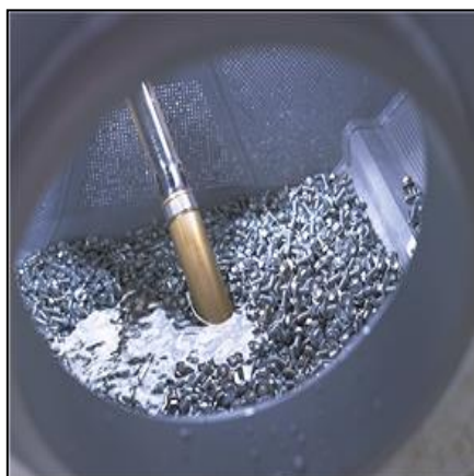
Obrázek 10 Šrouby v procesu galvanického zinkování
