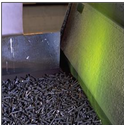
Obrázek 9 Šrouby před vstupem do kalicí pece
