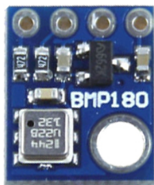
Obr. 2.6: Senzor Bosch BMP180.
