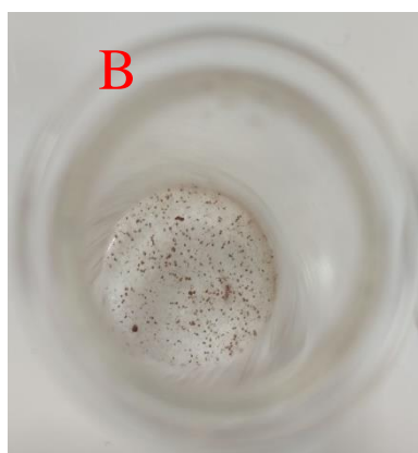
Obrázek č. 17: Na obrázku A jsou vzorky vysráženého červeného kalu o koncentraci 0,05 % v emulzích vody a oleje s různou koncentrací oleje. Na obrázku B je detail vysráženého kalu v emulzi.
