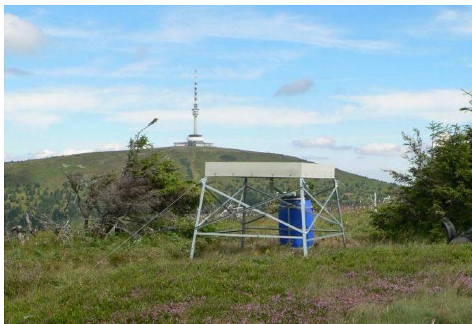
Obr. 15. Zařízení na jímání dešťové vody na lokalitě Petrovy kameny (foto: Pavlína Škrottová)
