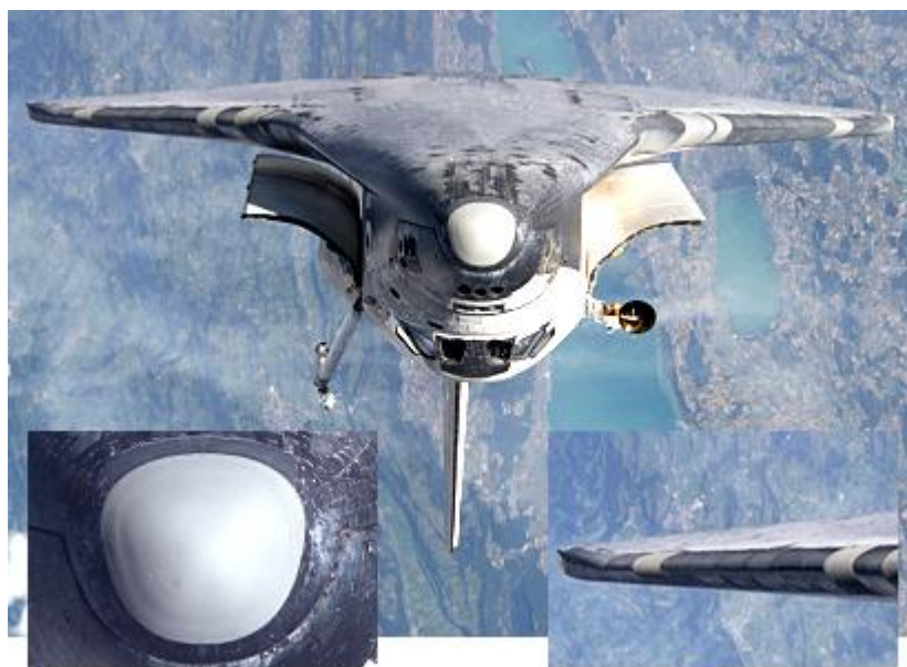
Obr. 33 Tepelná ochrana z kompozitu uhlík-uhlík na raketoplánu [38].
