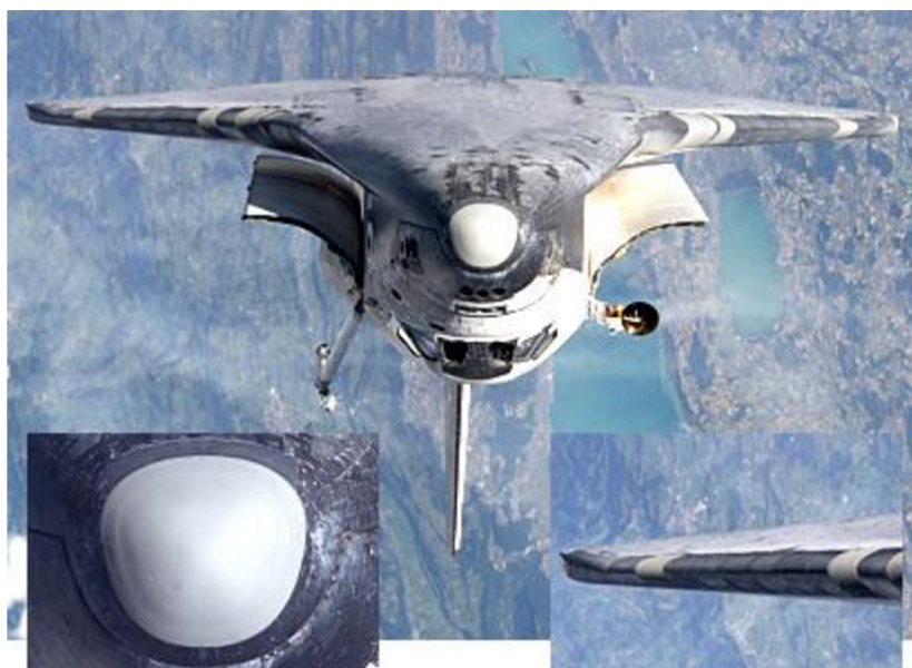
Obr. 33 Tepelná ochrana z kompozitu uhlík-uhlík na raketoplánu [38].
