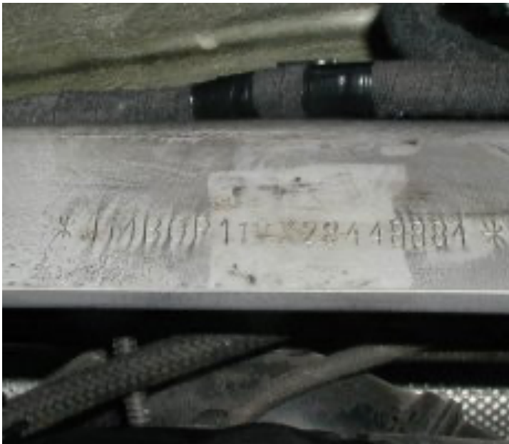
Obrázek 5: Falza čísla karoserie vozidla VIN
