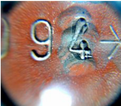
Obrázek 3: Falza čísla karoserie vozidla č. 2, původní číslice 5 přeražena na číslici 4
