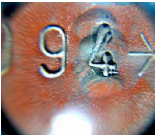
Obrázek 6: Falza čísla karoserie vozidla č. 2, původní číslice 5 přeražena na číslici 4
