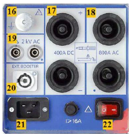
Obr. 9- 2 – Vysokonapěťové a proudové výstupy [12]
