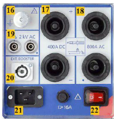
Obr. 9- 2 – Vysokonapětové a proudové výstupy [12]
