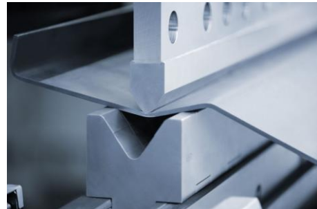
Obr. 15 Jednoduchého ohýbání do tvaru U [2] Obr. 16 Ohyb na ohraňovacím lisu [12]
