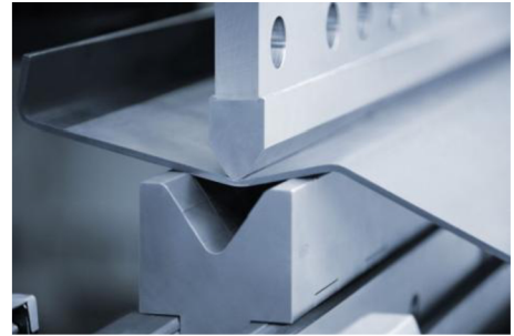
Obr. 15 Jednoduchého ohýbání do tvaru U [2] Obr. 16 Ohyb na ohraňovacím lisu [12]
