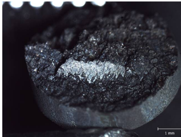
Obr. 11.3: Lomová plocha vzorku 7 (stereolupa), \varepsilon_a = 0,52\% , N_f = 244 , \varepsilon_{ap} = 7,17242 \cdot 10^{-4} , \sigma_a = 725,68 MPa.
