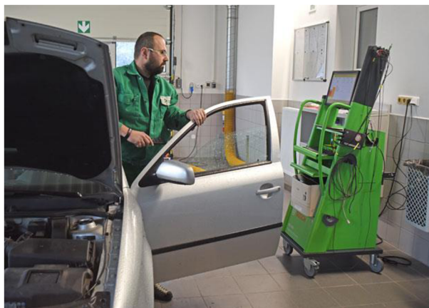
Obr. 19 – Měření emisí na SME [36]
