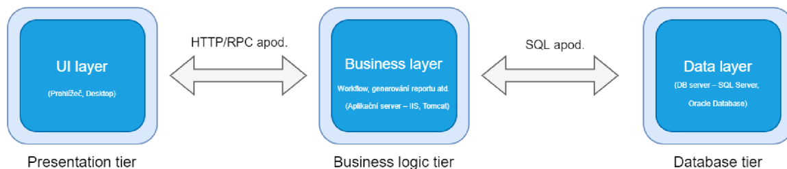
Obrázek 2.3: Ukázka rozložení layers mezi tiers – vrstvy – ve třívrstvé architektuře, inspirováno a doplněno [5]
