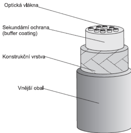
Obrázek 8 - Struktura optického kabelu
