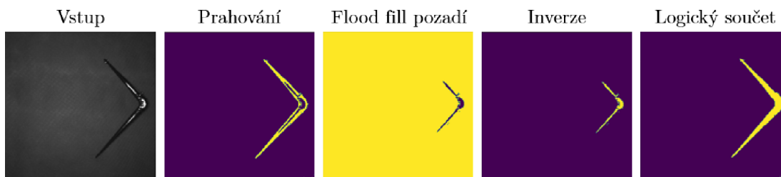
Obr. 2.5: Postup segmentace kovového dílu a pozadí
