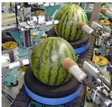
Obrázek č. 4 Akustický systém jako součást automatické třídící linky (Sun et al., 2010)
