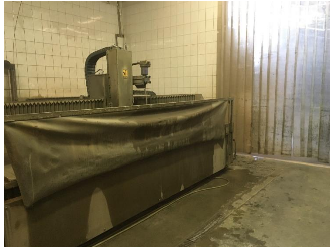
Obr. 9 Vodní paprsek na dělení materiálu 112
