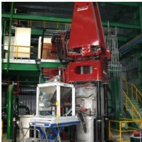
Obr. 26: Pec pro elektrostruskové tavení firmy Consarc (1000 mm) [14]
