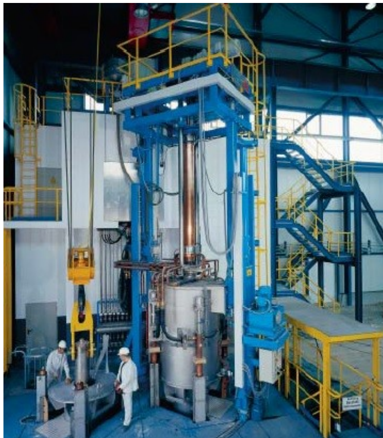
Obr. 24: Pec pro elektrostruskové tavení pod ochrannou atmosférou (20 tun) [16]
