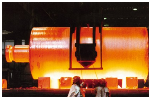
Obr. 28: Ingot (165 tun, průměr 2300 mm, délka 5000 mm) [16]
