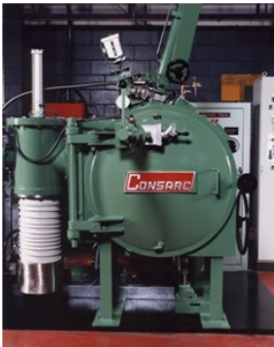
Obr. 12: Jednokomorová horizontální vakuová indukční pec hutního typu firmy Consarc [8]
