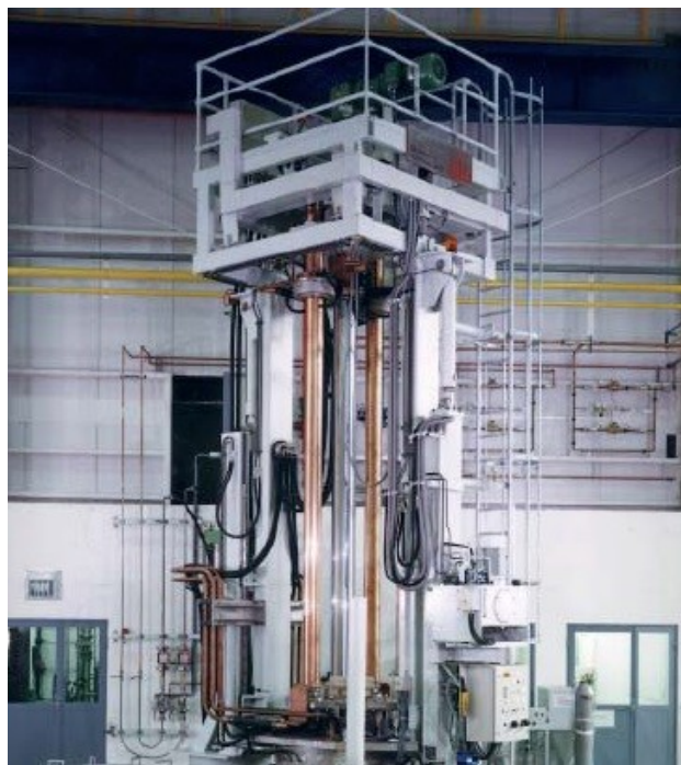
Obr. 23: Pec pro elektrostruskové tavení (16 tun, max. tlak 16 bar) [16]
