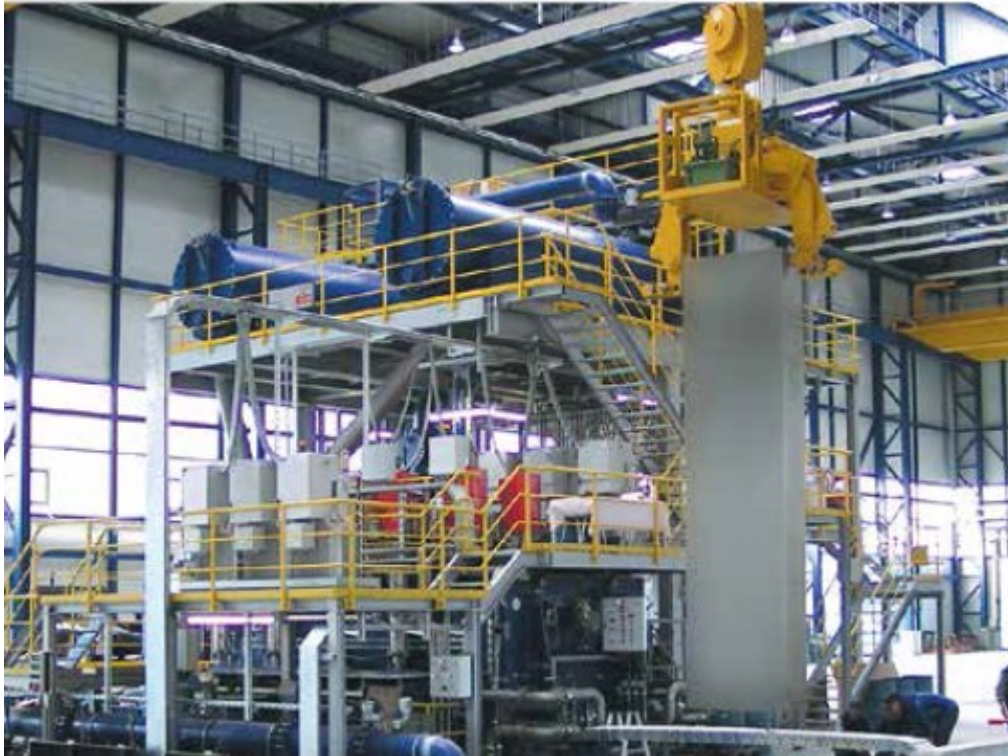
Obr. 36: Pec pro výrobu ingotů z reaktivních materiálů za použití elektronového svazku o síle až 4800 kW (hmotnost ingotu až 20 t) [29]
