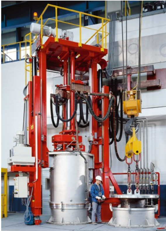
Obr. 31: Vakuová oblouková pec firmy ALD (30 tun) [25]
