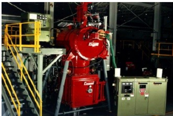
Obr. 16: Dvoukomorová vakuová indukční pec s vodou chlazeným měděným kelímkem s vertikálním uspořádáním komor firmy Consarc [8]
