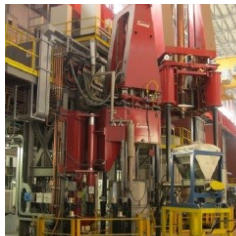
Obr. 27: Pec pro elektrostruskové tavení firmy Consarc (1200 mm) [14]
