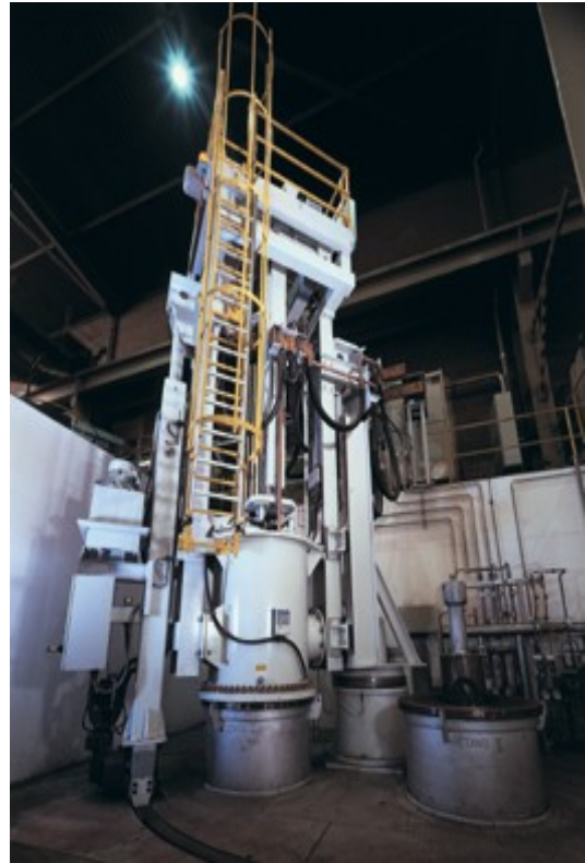
Obr. 32: Vakuová oblouková pec firmy ALD (12 tun) [25]
