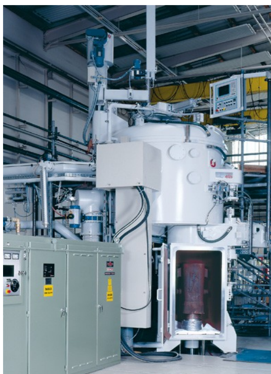
Obr. 17: Dvoukomorová vakuová indukční pec s vertikálním uspořádáním komor slévárenského typu firmy ALD [7]
