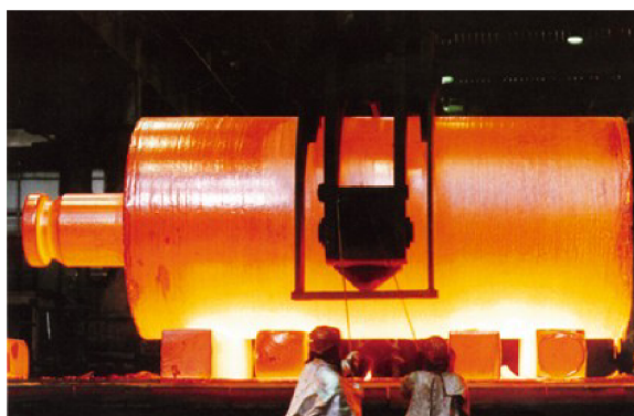
Obr. 28: Ingot (165 tun, průměr 2300 mm, délka 5000 mm) [16]
