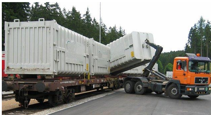
Obr. 11: Překládka kontejneru systémem ACTS
