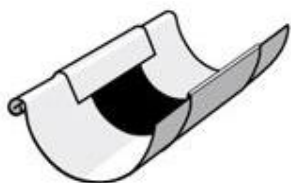
Obrázek [48]: Žlabová dilatace
