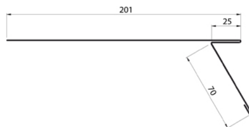
Obrázek [102]: Zatahovací okapový plech LINDAB FSRP - rozvinutá šířka
