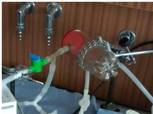
Obr. 24 – Vzorkovací komora o objemu 0,65 l
