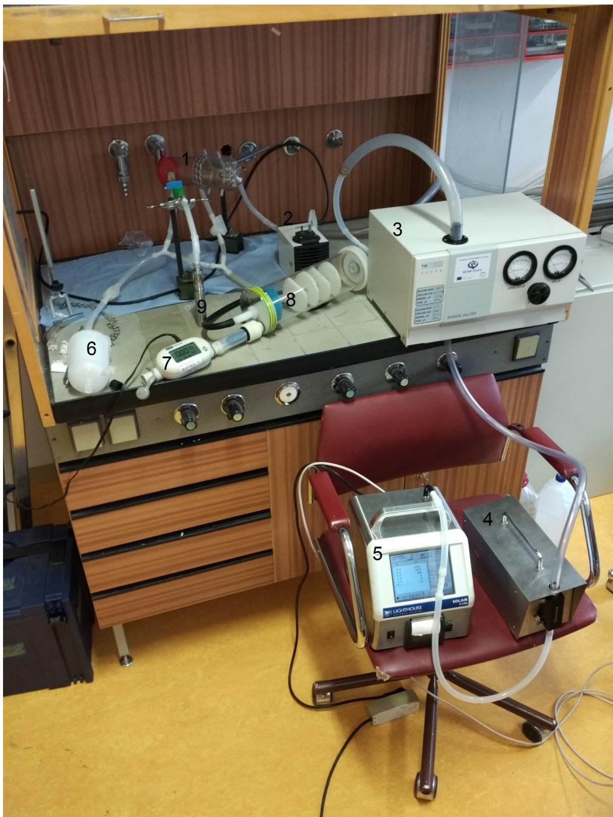
Obr. 25 – Zapojení měřicí trati (1- Vzorkovací komora o objemu 0,65 l, 2 – Vakuová pumpa, 3 – Dilutor TSI 3302A, 4 – Dilutor DIL 554, 5 – SOLAIR 3100, 6 – HEPA filtr 7 – Průtokoměr 8- Ředící komora, 9 – Měřená elektronická cigareta)
