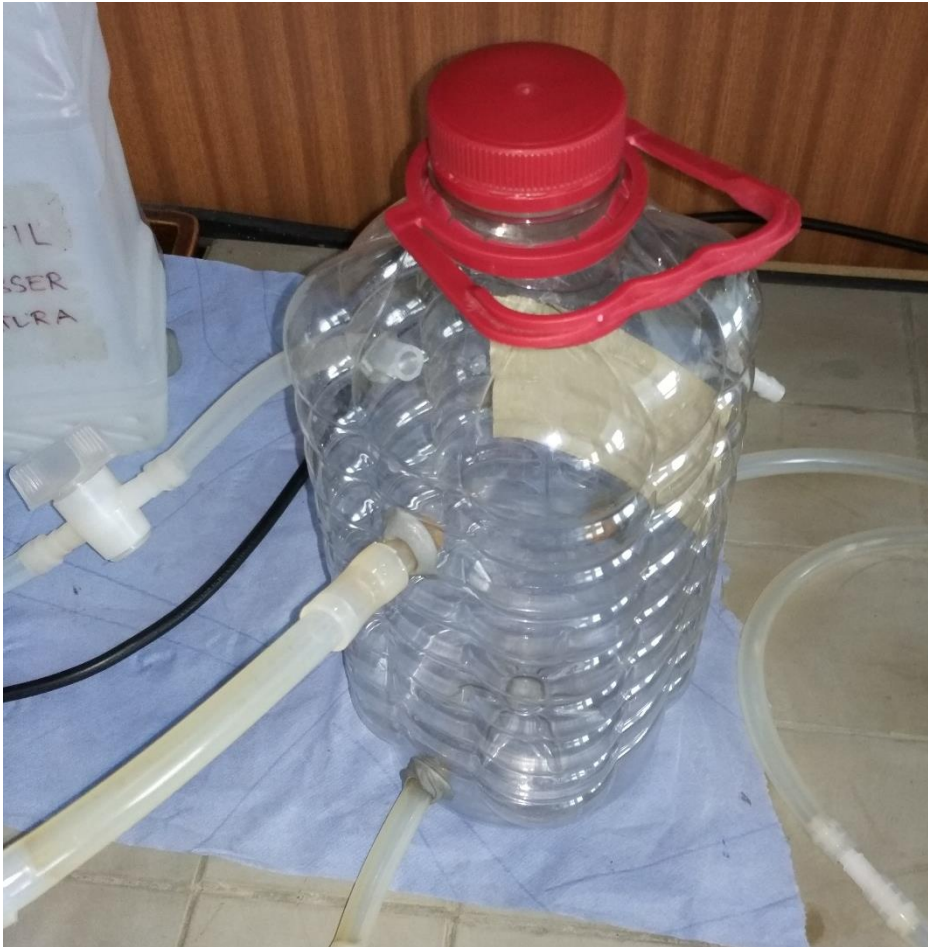
Obr. 26 – Vzorkovací komora o objemu 3,2 l
