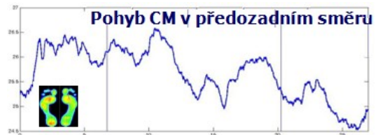
Obrázek 5. Minimální hodnota 24,50 mm byla dosažena CM v průběhu 26. s - max. hodnotu 26,52 mm dosáhlo CM ve 11. s. (L. B., 2011).
