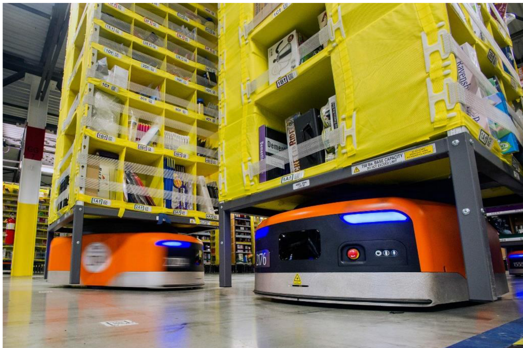
Obrázek 8: Roboti Kiva pro přesun regálů se zbožím až ke třídícím. [17]
