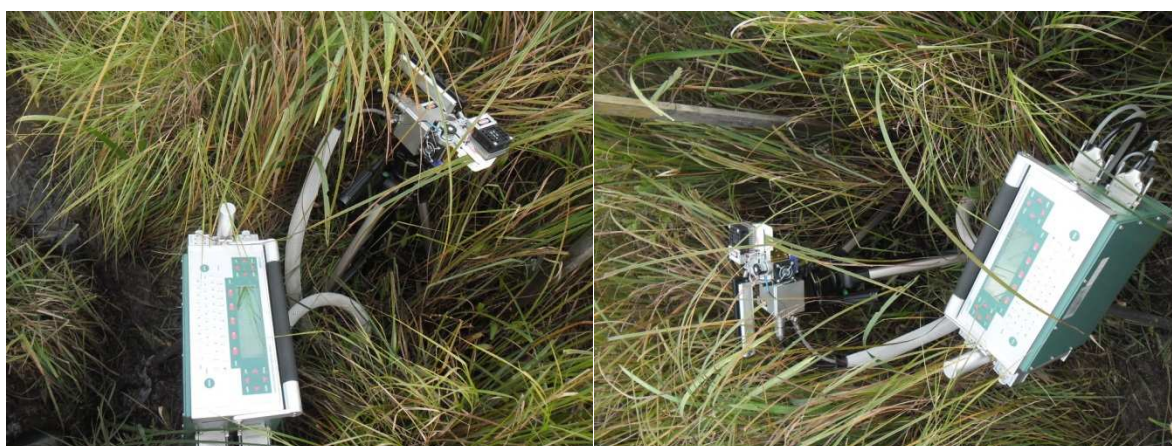
Příloha 3.2: Měření světelných křivek fotosyntézy na listech ostřice ( Carex acuta ) přenosným systémem pro měření fotosyntézy LI-6400 (LI-COR Biosciences, USA).
