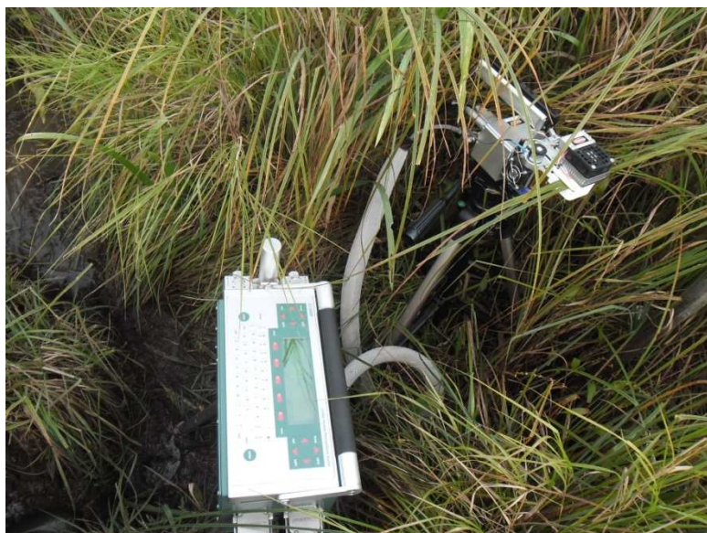
Obrázek 3: Systém pro měření fotosyntézy LI-6400 při měření fotosyntézy C. acuta na Mokřých loukách u Třeboně.
