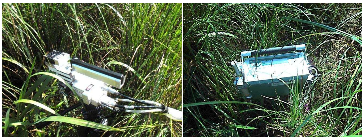
Příloha 3.1: Měření světelných křivek fotosyntézy na listech chrastice ( Phalaris arundinacea ) přenosným systémem pro měření fotosyntézy LI-6400 (LI-COR Biosciences, USA).
