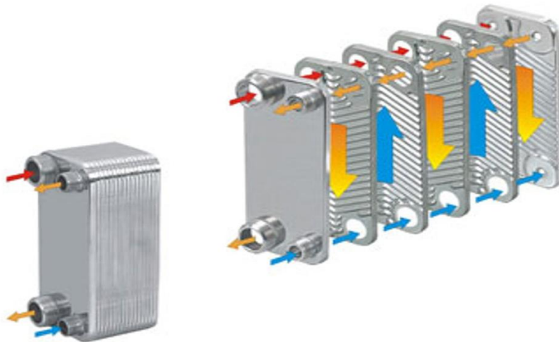
Obrázek 1.5 Schéma proudění média v deskovém výměníku [5]
