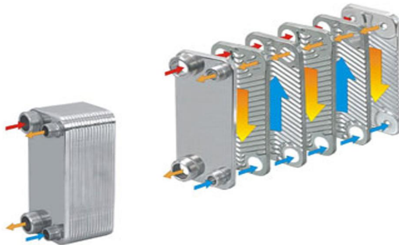
Obrázek 1.5 Schéma proudění média v deskovém výměníku [5]
