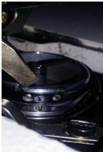
Obrázek 18. Nastavení napětí pro spodní nit
