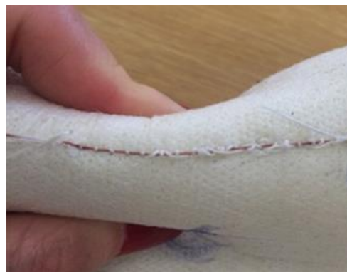
Obrázek 28. Napětí horní nitě je příliš vysoké, nit se trhá v šicím stroji
