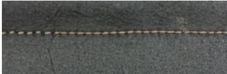
Obrázek 27. Bod provázání se protahuje na lícni stranu textilie
