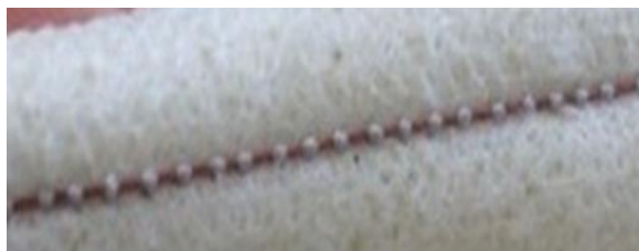
Obrázek 25. Spodní nit vytahuje horní dolů
