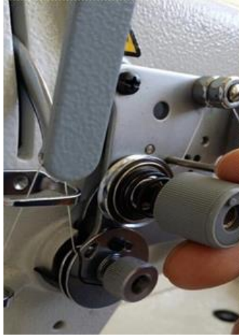
Obrázek 17. Nastavení napětí pro horní nit
