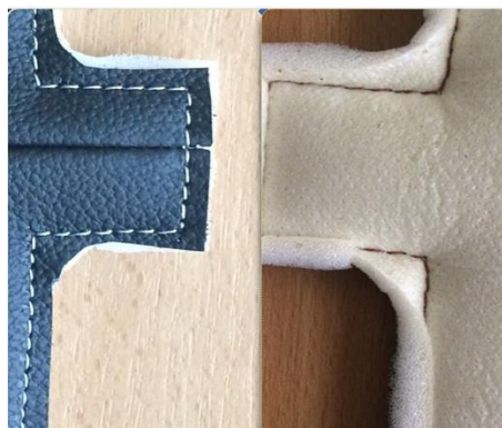
Obrázek 26. Ideální šev s vazným bodem uprostřed
