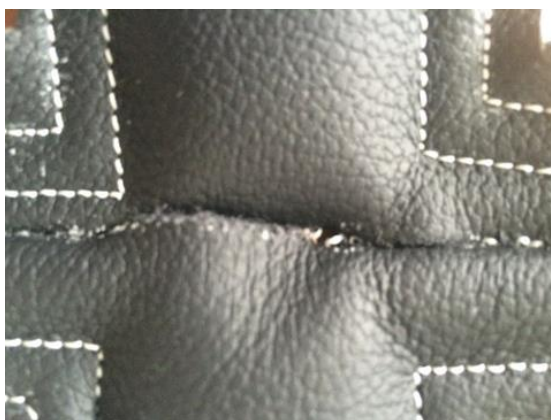
Obrázek 29. Přetrh niti ve švu
