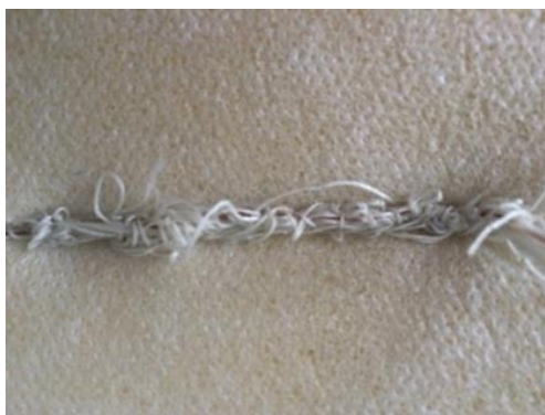
Obrázek 24. Napětí horní niti je příliš malé
