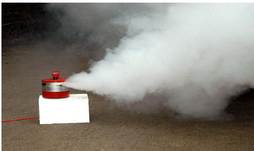
Obrázek 7 Vypouštění aerosolu z generátoru systému FIRE JACK, zdroj: (BESY spol. s r. o., 2017)
