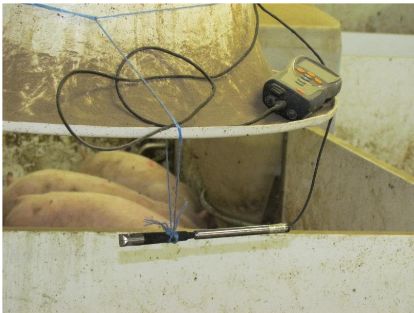
Obrázek 3.5: Umístění vrtulkové sondy
