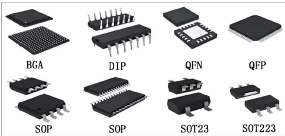
Obrázek 1.1: Různé typy pouzder integrovaných obvodů [21]
