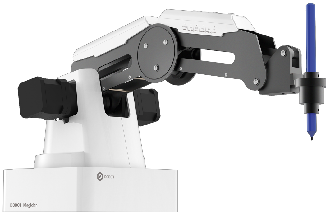
Obrázek 2.3: Robotická ruka Dobot Magician. Jedná se o kloubového čtyřosého robota, který je určen hlavně pro domácí a edukativní účely. 4
