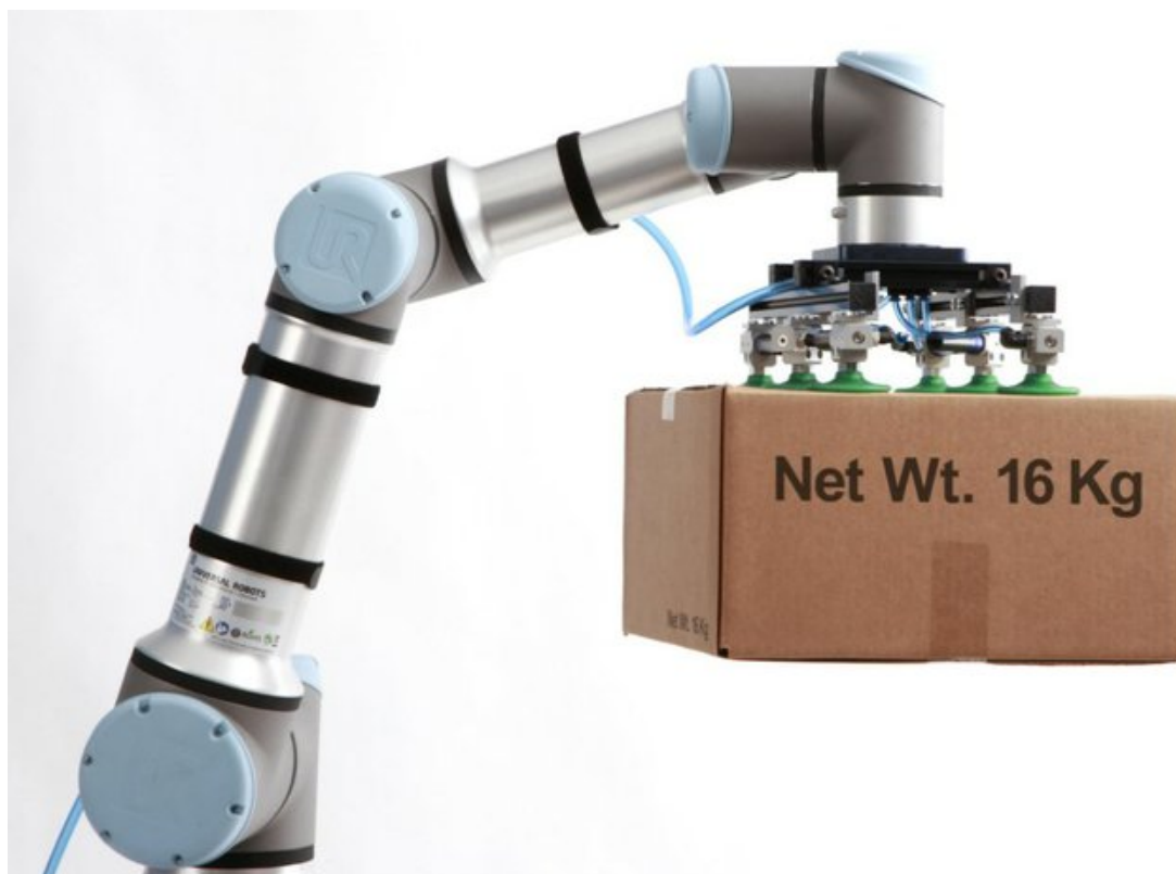
Obrázek 2.2: Ukázka cobota - kolaborativní robotické ruky. 2
