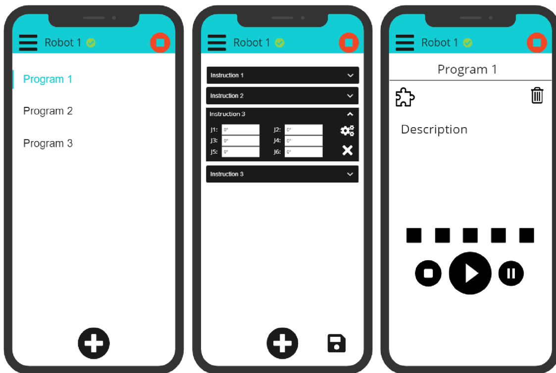
Obrázek 3.6: Další skicy grafického návrhu grafického rozhraní aplikace. Nalevo výběr programů pro robota, napravo rozhraní pro spouštění a ovládání a uprostřed prostředí pro vytváření a úpravu programů.
