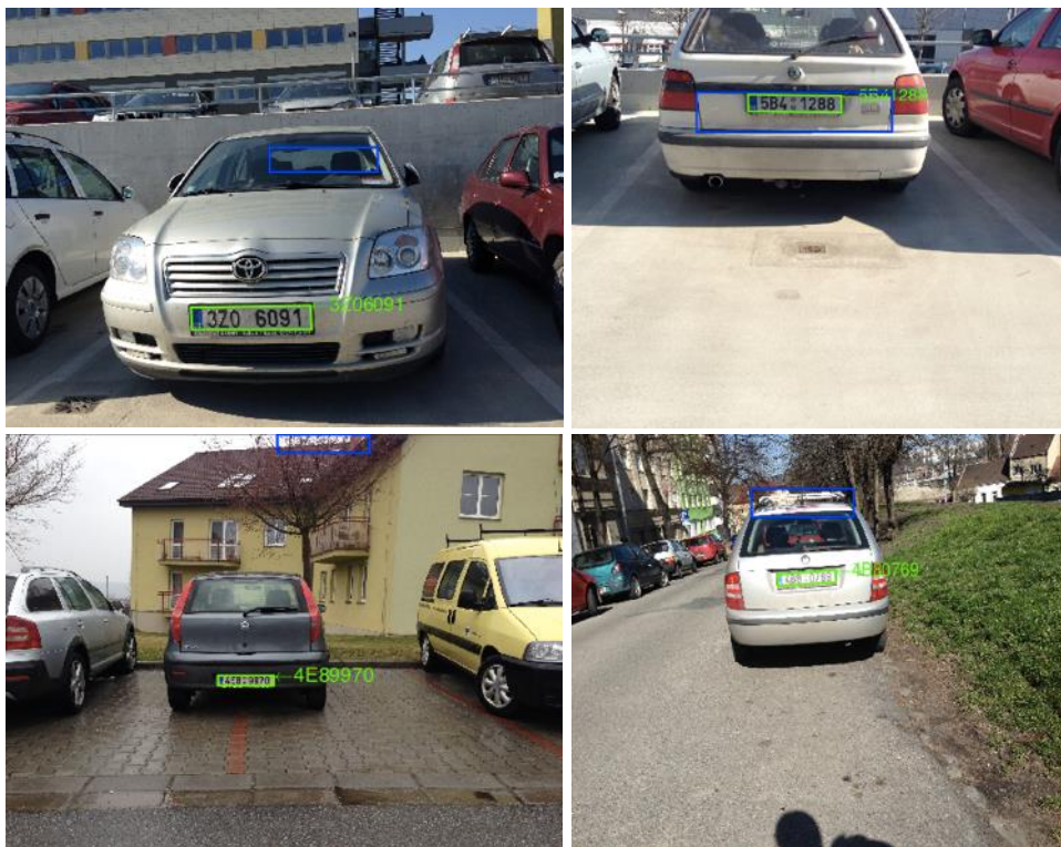
Obr. 6.5: Některé chybně detekované registrační značky metodou trkal_bp , správné řešení zeleně, nalezené modře
