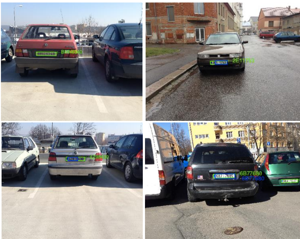
Obr. 6.6: Některé chybně detekované registrační značky metodou trkal_dp , správné řešení zeleně, nalezené modře
