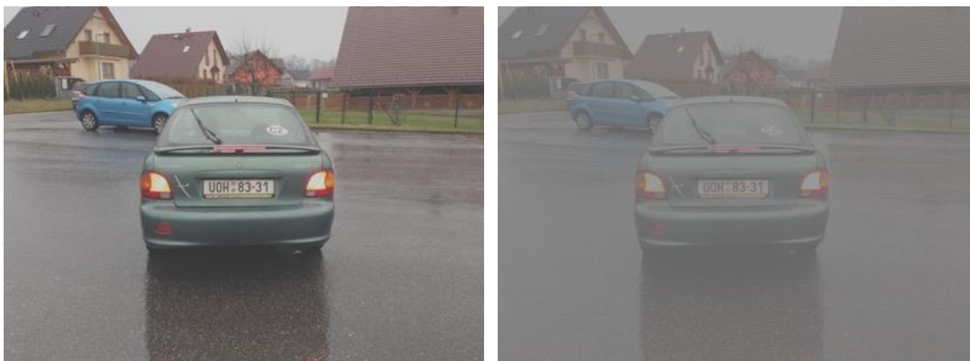
Obr. 6.13: Příklad ze sady simulující snížení kontrastu, vlevo na 60 %, vpravo na 20 %
