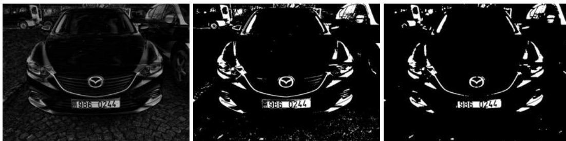
Obr. 4.6: Top-hat obraz (vlevo), binární obraz a obraz s odstraněnými detaily (vpravo)
