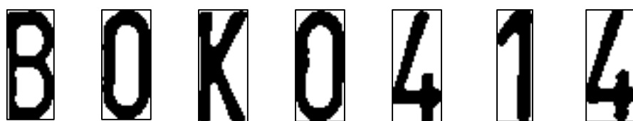
Obr. 5.9: Reálný výstup ze separačního algoritmu využívajícího geometrických podmínek
