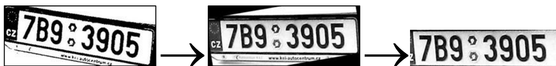
Obr. 5.5: Korekce natočení, zleva – prahování, rotace, odstranění okrajů z rotace
