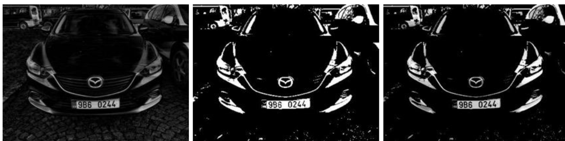
Obr. 4.14: Zleva: obraz po bottom-hat, binární mapa kandidátů, aplikovaná binární mapa na šedotónovém snímku
