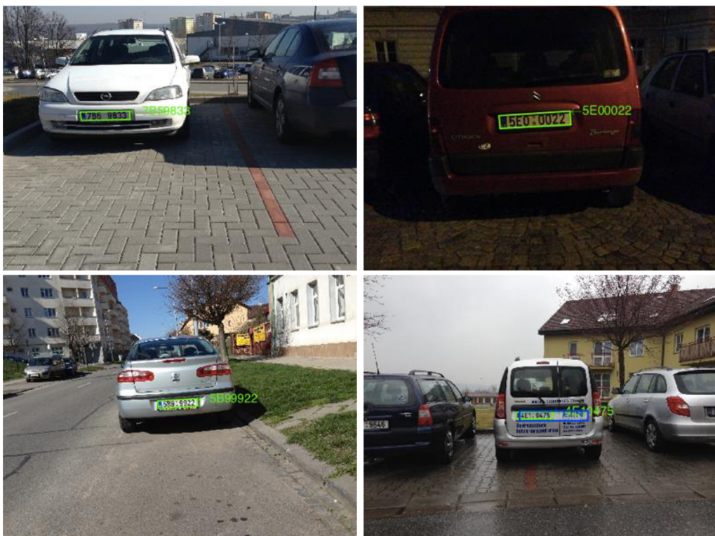
Obr. 6.2: Některé chybně detekované registrační značky metodou mahini, správné řešení zeleně, nalezené modře
