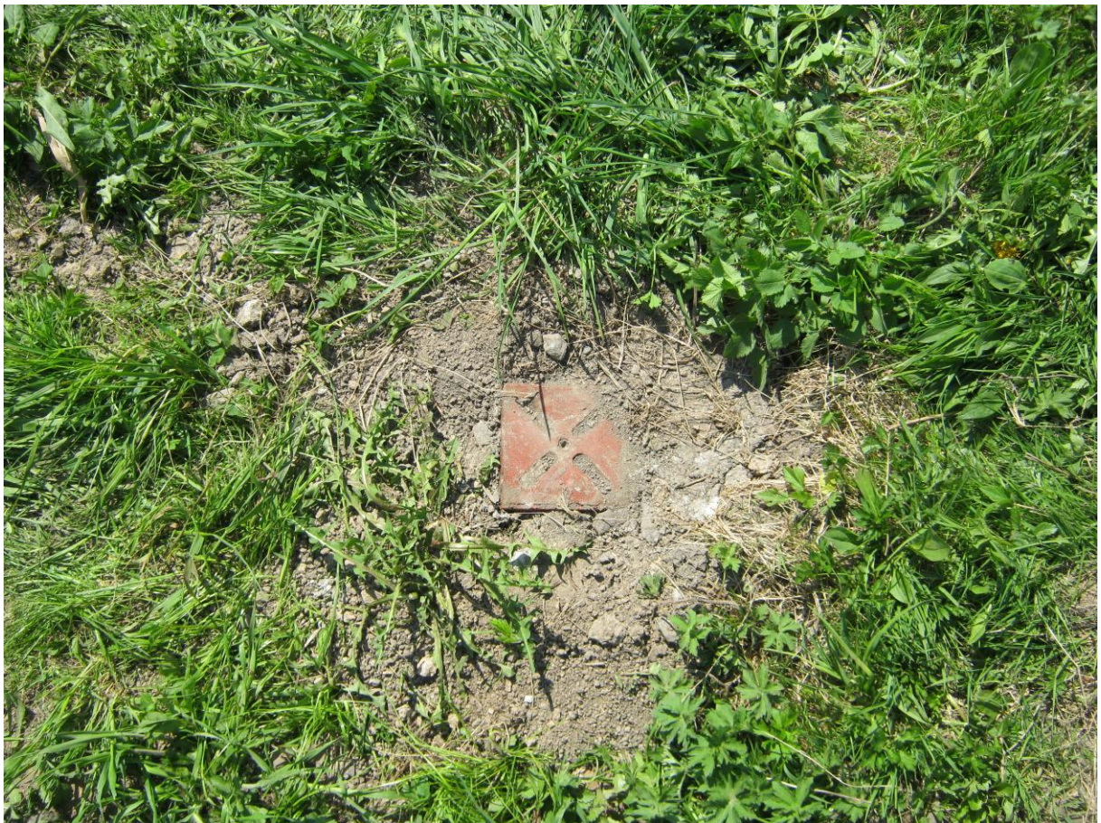
Obr. č. 6: Ukázka nově zřízeného bodu PPBP
