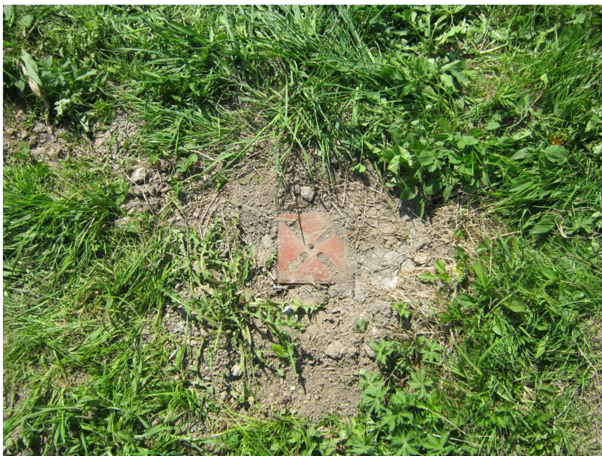
Obr. č. 6: Ukázka nově zřízeného bodu PPBP
